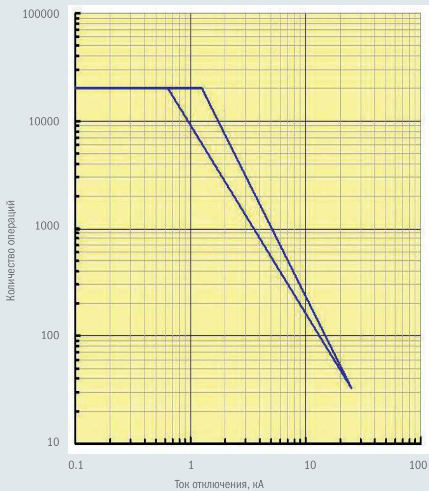
График дугогасительной камеры камеры LV3-P на 12 кВ (компактный тип)
